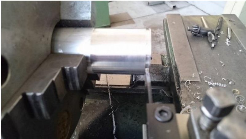
Figura 3.5 Corte de la placa de orificio
