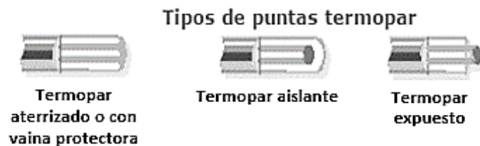
Figura 1.9 Puntas en una sonda termopar.
