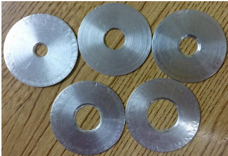
Figura 3.6 Placas de orificio fabricadas de diferentes diámetros.
