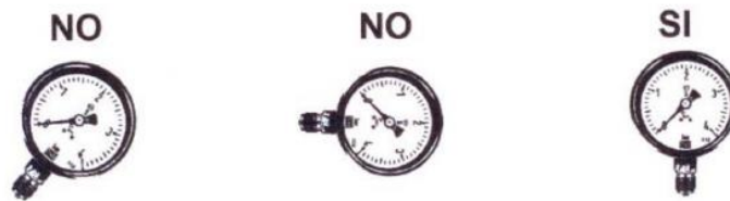
Figura 3.10 Posición adecuada de los manómetros en el proceso
