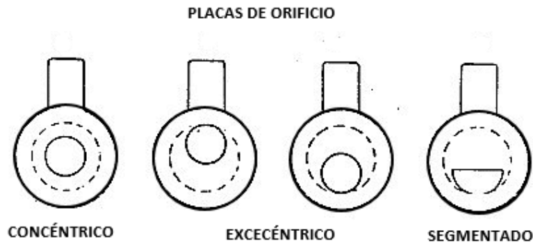
Figura 1.15 Diferentes perforaciones de la placa de orificio
