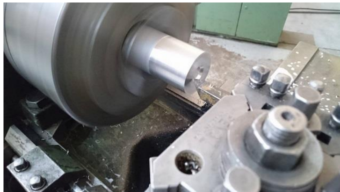
Figura 3.4 Ángulo a 45° en la placa de orificio.
