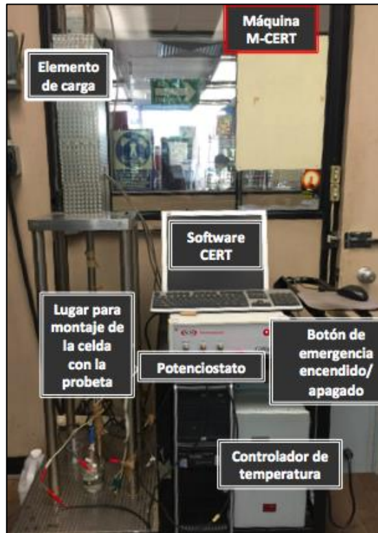
Figura 1.9. Máquina M-CERT empleada para pruebas de tensión a velocidad de deformación lenta (SSRT).
