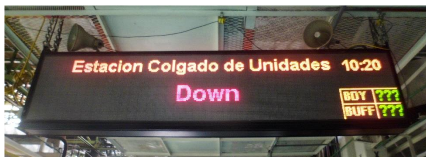
Figura 5.12 Pantalla del pizarrón de andón de la pantalla en falla (down)
