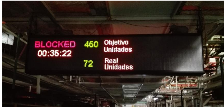
Figura 5.14 Pizarrón de andón bloqueado (blocked)
