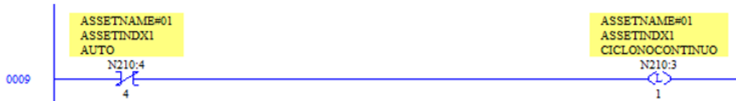
Figura 5.10 Activación en PLC de la pantalla en falla (Down)
