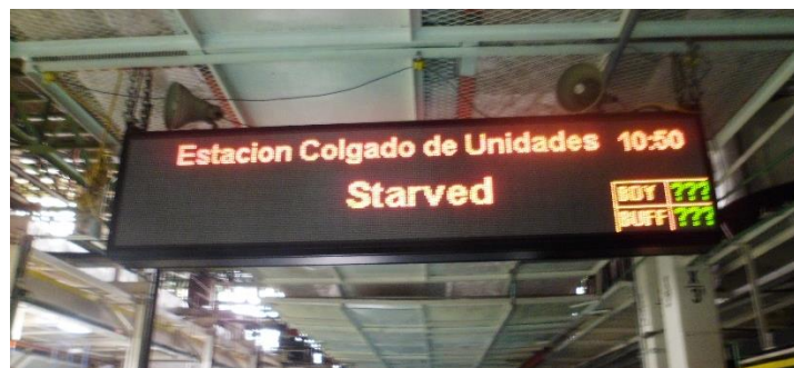
Figura 5.9 Pantalla del pizarrón de andón de la pantalla en espera (starved)
