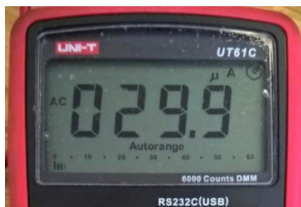
Fig. 4.4.2. Corriente eficaz medida del modo de programa 3, sin ningún regulador, es decir, corriente máxima eficaz.
