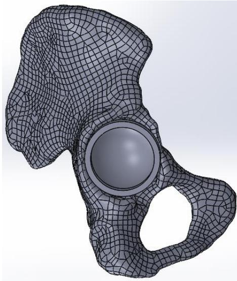
Figura 3.44. Copa colocada dentro del cuerpo del acetábulo.
