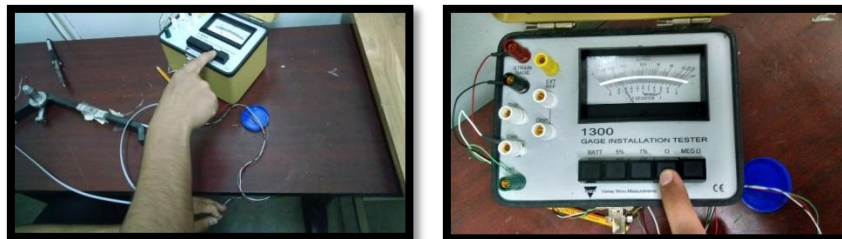
Fig. 3.32 Procedimiento para comprobar un correcto soldado de los alambres conductores en la galga.
