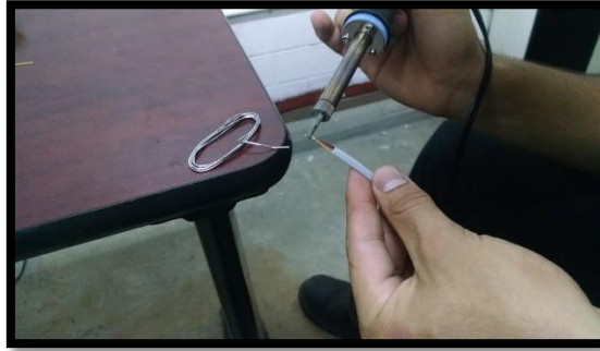
Fig. 3.30 Estañado de las puntas de los alambres conductores que posteriormente serían soldadas a las galgas extensométricas.
