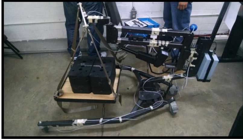
Fig. 3.35 Imagen de la grúa cargando 36 kg.
