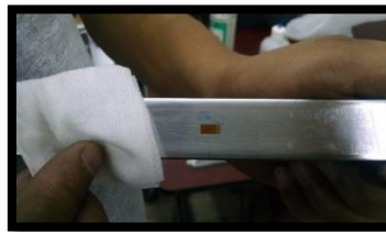
Fig. 3.26 Galga pegada y alineada con los ejes de referencia trazados.
