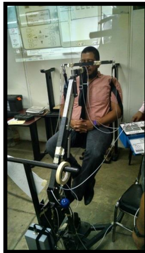
Fig. 3.37 Prueba de la grúa en donde se muestra el brazo telescópico completamente extendido y en posición máxima, utilizando a una persona de alrededor de 120 kg.
