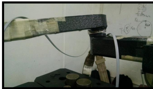
Fig. 4.8 Comportamiento de la pieza pivote de la horquilla ante un peso de 200 kg.
