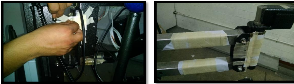
Fig. 3.43 Protección de papel y cinta masking puesta sobre los pedazos de resina recién pegados en las zonas de interés de los distintos componentes de la grúa.
