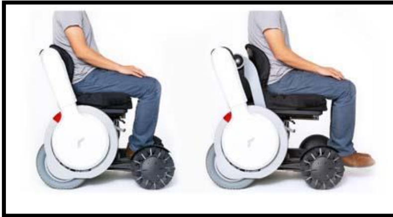
Fig. 1.14 El avance del asiento de la Silla Whill facilita la transferencia del paciente (ADAPTADO.es, 2014).
