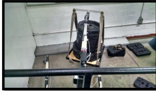
Fig. 4.6 Notable desalineación del marco con respecto a su eje longitudinal, debido a la inclinación del suelo, ante una carga de 230 kg.
