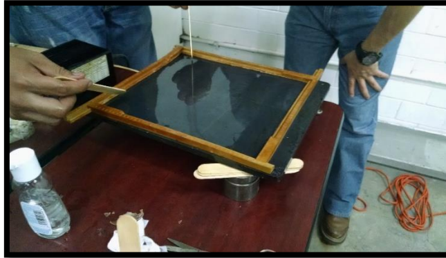
Fig. 3.42 Hoja de resina fotoelástica obtenida, previa a ser retirada de la plancha y seccionada para ser usada sobre los puntos críticos de la grúa.
