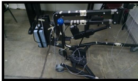
Fig. 3.33 Imágenes de la grúa completamente instrumentada con galgas extensométricas listas para ser utilizadas en las pruebas.
