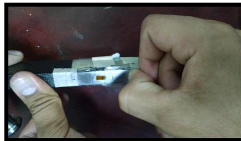
Fig. 3.29 Retiro de la cinta celofán de una de las galgas pegadas.
