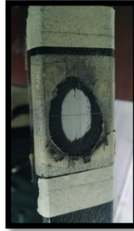
Fig. 3.25 Ejes de referencia marcados en una de las áreas que fue instrumentada con galga extensométrica.
