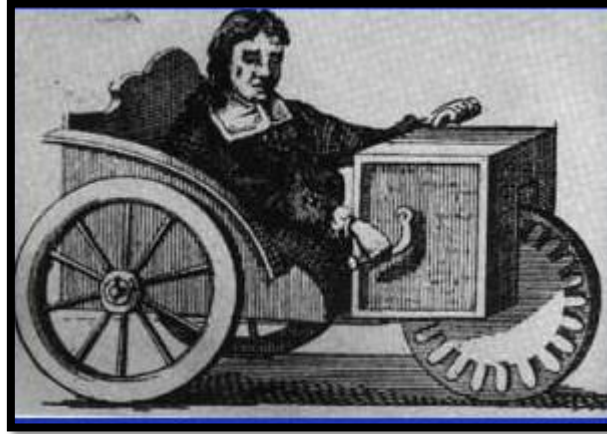
Fig. 1.6 Silla de Stephen Farfler de accionamiento manual (Báez Martínez, 2014).
