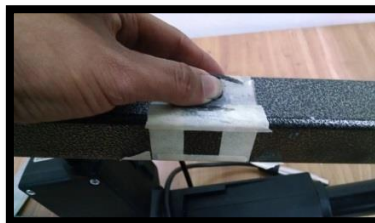
Fig. 3.27 Imagen que muestra el procedimiento de hacer presión directamente con el dedo pulgar sobre la cinta celofán que cubre la galga recién pegada, a fin de ayudar en la adhesión de la misma con la superficie.
