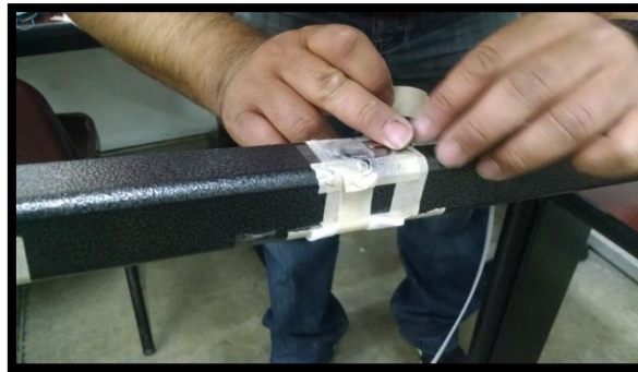
Fig. 3.31 Soldado de los alambres conductores a una de las galgas.
