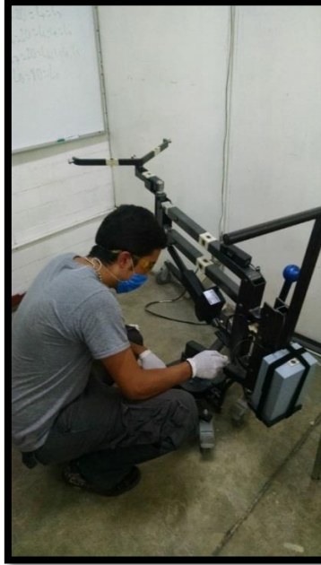
Fig. 3.23 Aplicación del removedor de pintura sobre las áreas en donde posteriormente se pegaron las galgas extensométricas.
