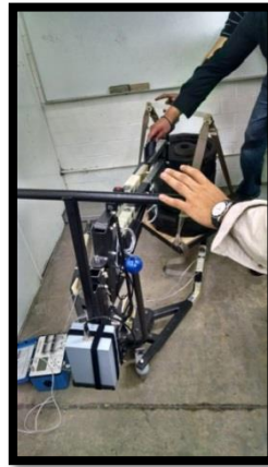
Fig. 4.7 Falla del soporte del marco y por consecuencia no fue posible que la grúa mantuviera, por acción propia, el peso que se le cargó (230 kg).
