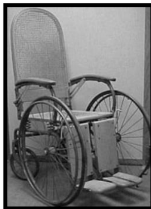
Fig. 1.9 Silla de ruedas que incorpora radios de alambre y aros de empuje (Pontificia Universidad Javeriana, 2013).
