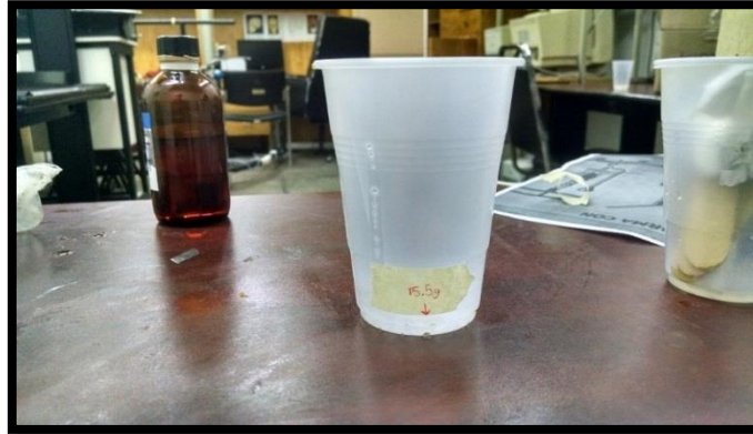
Fig. 3.39 Vaso utilizado para pesar la cantidad necesaria de resina y catalizador de la mezcla.
