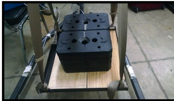
Fig. 3.34 Pesas utilizadas para la realización de las pruebas en la grúa.
