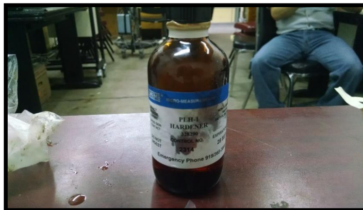
Fig. 3.41 Catalizador PLH-1 Marca Vishay MicroMeasurements®.
