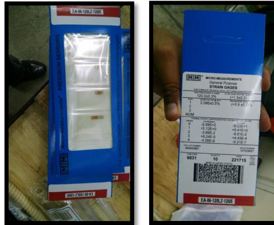
Fig. 3.28 Paquete de galgas aplicadas a la grúa durante las pruebas.
