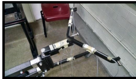
Fig. 3.33 Imágenes de la grúa completamente instrumentada con galgas extensométricas listas para ser utilizadas en las pruebas.
