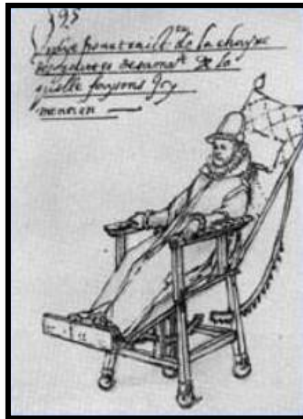
Fig. 1.5 Primer silla de ruedas diseñada para el transporte de personas de la que se tiene registro. Equipada con 4 ruedas pequeñas, reposapiés e incluso respaldo reclinable (Báez Martínez, 2014).
