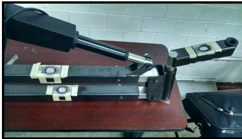
Fig. 3.24 Zonas de interés del marco, libres de pintura y listas para ser marcadas con los ejes de referencia para pegar las galgas.
