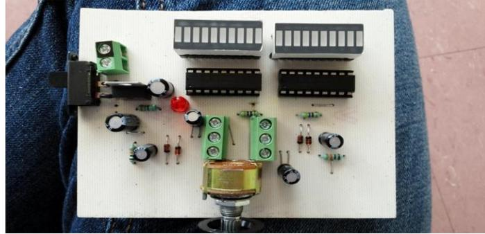
Figura 3-10 Placa medidor de señal terminada. Vista componentes
