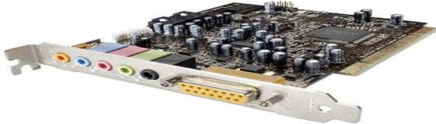
*Figura 2-2 Tarjeta de sonido PCI*
