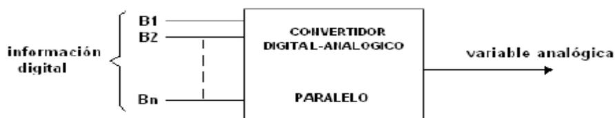
Figura 1-10 Diagrama general de un convertidor paralelo.
