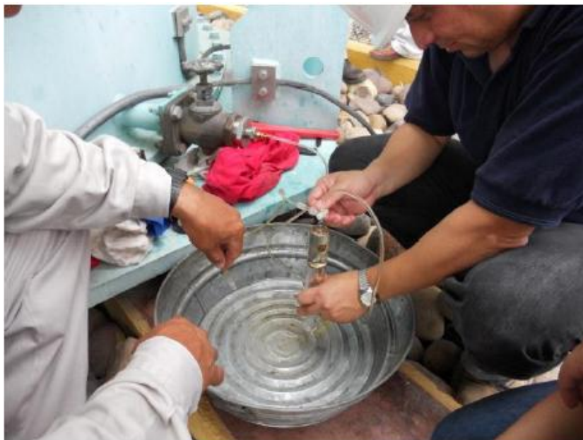
Figura 2.2 Extracción de la muestra para la técnica de cromatografía de gases
