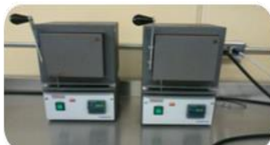
Figura 8. Equipo utilizado para el tratamiento térmico.
