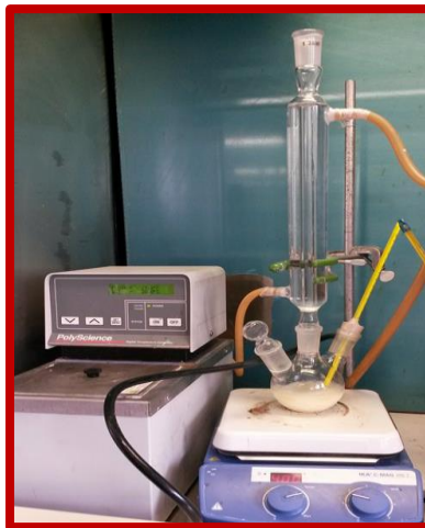
Figura 9. Equipo para el proceso de transesterificación.
