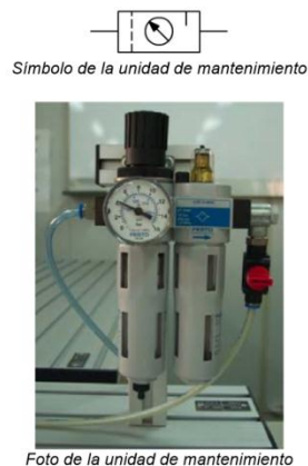
Figura 1.36 Unidad de mantenimiento y símbolo.
