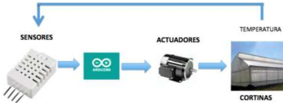
Figura 3.18 Diagrama del control de temperatura.
