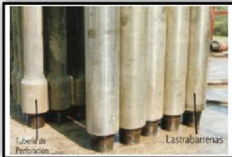
Figura 5.31 Tubería de Perforación y Lastra barrenas (Diplomado de Perforación, Esteban Vázquez Morales, Grupo AGP, 2013).
