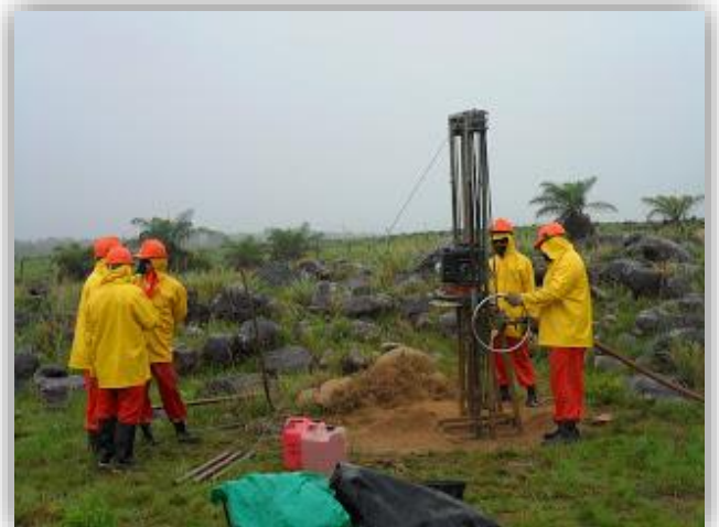
Figura 3.11 Perforación de un Punto de Disparo y 3.12 Perforación con Equipo de Aire (Petróleo: Prospección y Perforación, Richard Kraus, 2014).
