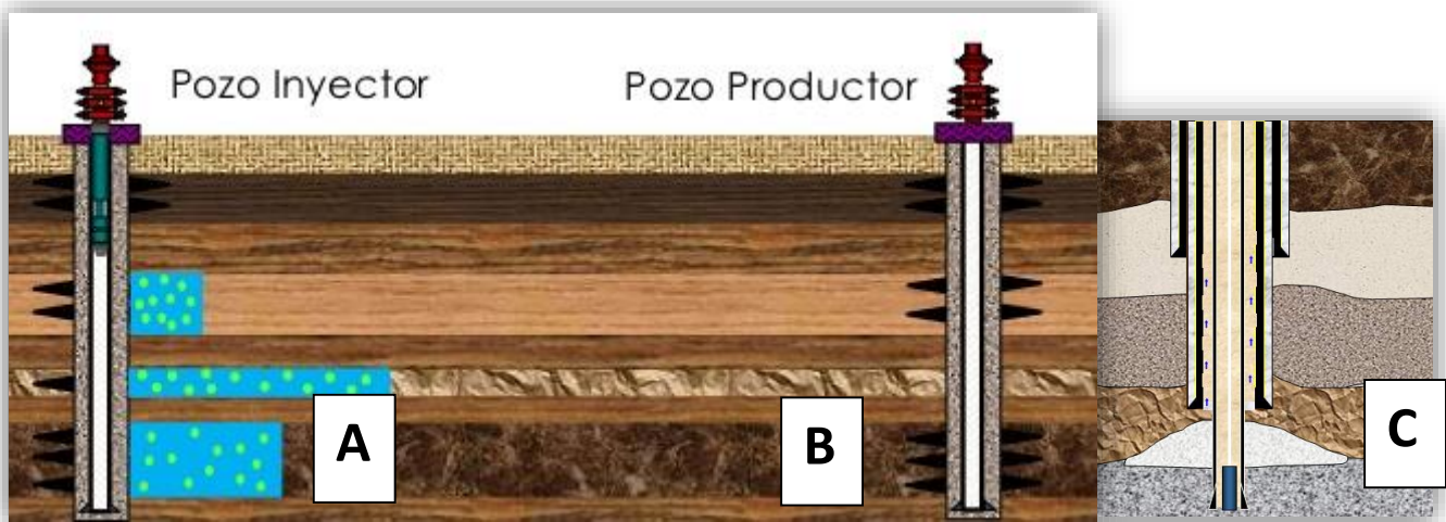
Figura 4.2 Clasificación de los Pozos según su Objetivo. a) Inyector. b) Productor. c) Estratégico (Evaluación Petrolera, Cárdenas Vences, G. y Arellano Gil, J., 2008).
