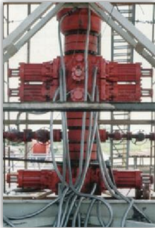
Figura 5.50 Conjunto de Preventores (BOP's) (Diplomado de Perforación, Esteban Vázquez Morales, Grupo AGP, 2013).
