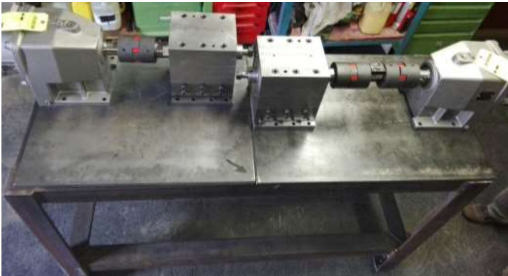
Figura 48. Ensamble del sistema de transmisión en la estructura
