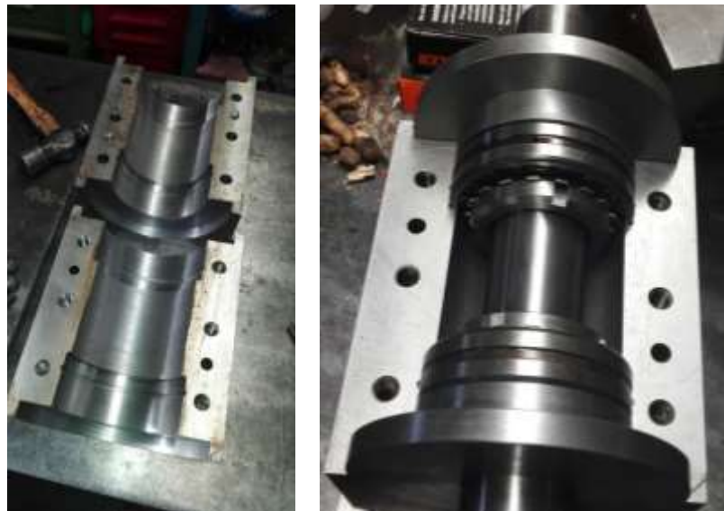
Figura 44. Maquinado interno de los Bearing housing y previo ensamble.
