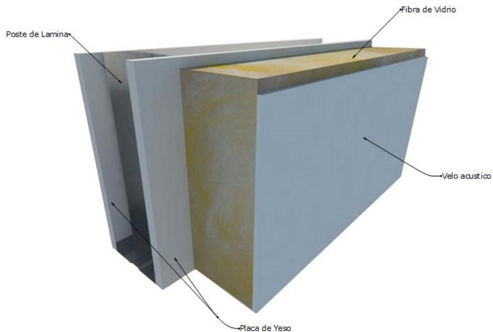
**Figura 3.18.** Vista en isométrico por capas de propuesta acondicionamiento acústico (fibra de vidrio con velo acústico) en muro constructivo Pasillo II-Sala I.
