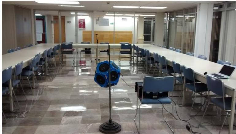
**Figura A9:** Vista Sala I, medición de inteligibilidad en punto B.
