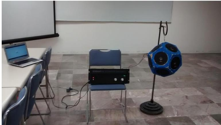
**Figura A7:** Conexión de fuente omnidireccional, amplificador y computadora.
