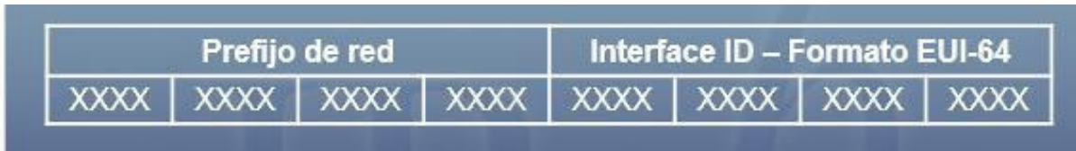
Figura 8. Formato de dirección IPv6.
