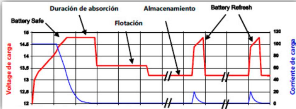
Figura 2.1.1.C Etapas de Cargado. Un cargador inteligente respeta cada una de las etapas mostradas en la figura.
