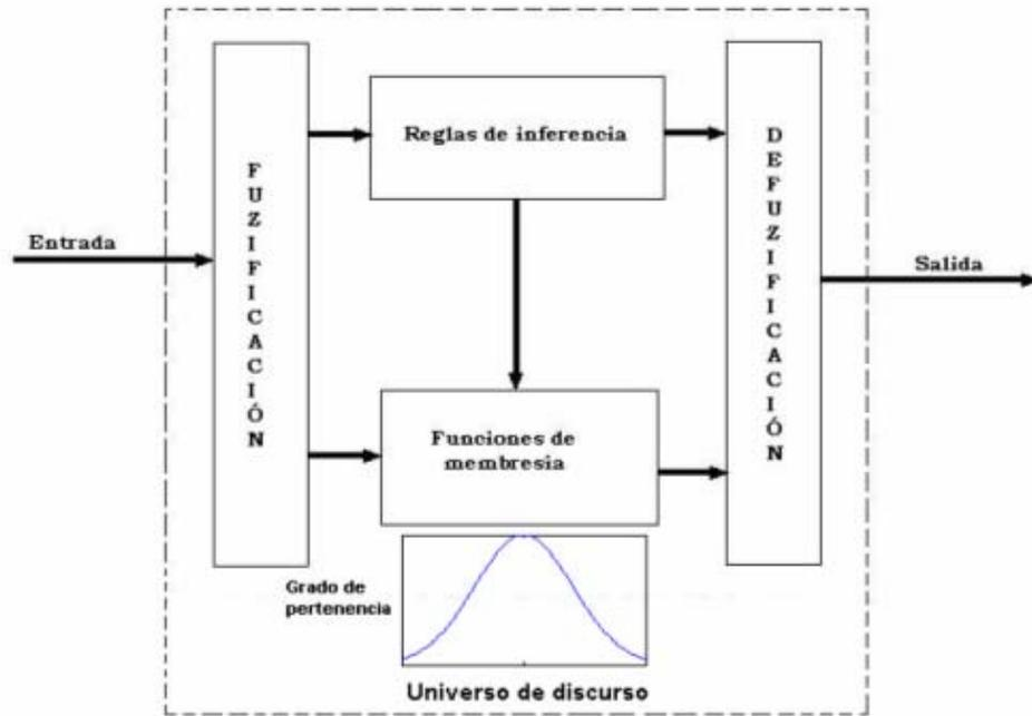
Figura 4.1: Estructura del controlador difuso
