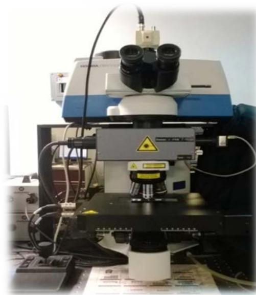
**Figura III. 3** Espectrómetro Raman (LAB-RAM). CNMN-IPN.
