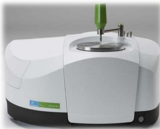
**Figura III. 2** Espectrómetro FTIR c/ATR (Spectrum Two). ESIQIE-IPN.
