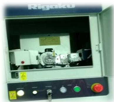
**Figura III. 1** Difractómetro de rayos X (Rigaku). CNMN-IPN.
