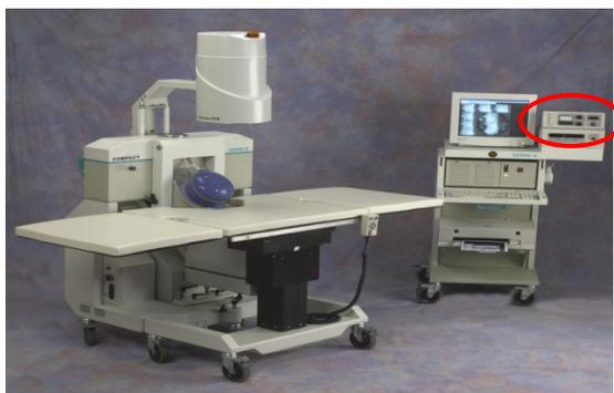
Figura 1. Equipo de LEOCH modelo "Compact", resaltado el modulo de control al cual se propone una mejora.
