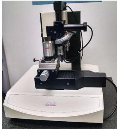
**Figura 3.8** Nanoindentador NHT, marca CSM. Cortesía del Centro de Nanociencias y Micro Nanotecnologías del IPN
