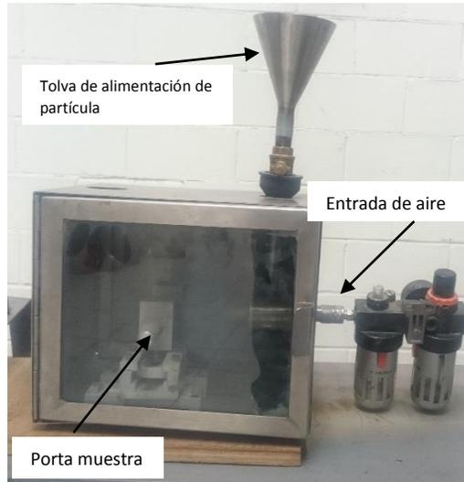
**Figura 2. 2** Máquina de erosión por partícula sólida, del Grupo Ingeniería de Superficies © SEPI Unidad Zacatenco
