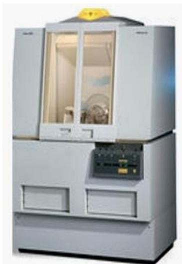
**Figura 3.6** Difractómetro X'Pert Pro MRD PANalytical. Cortesía del Centro de Nanociencias y Micro Nanotecnologías del IPN
