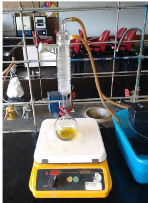
*Figura 39* Sistema para la determinación de DQO montado en el laboratorio de ingeniería ambiental de la ESIQIE-IPN.
