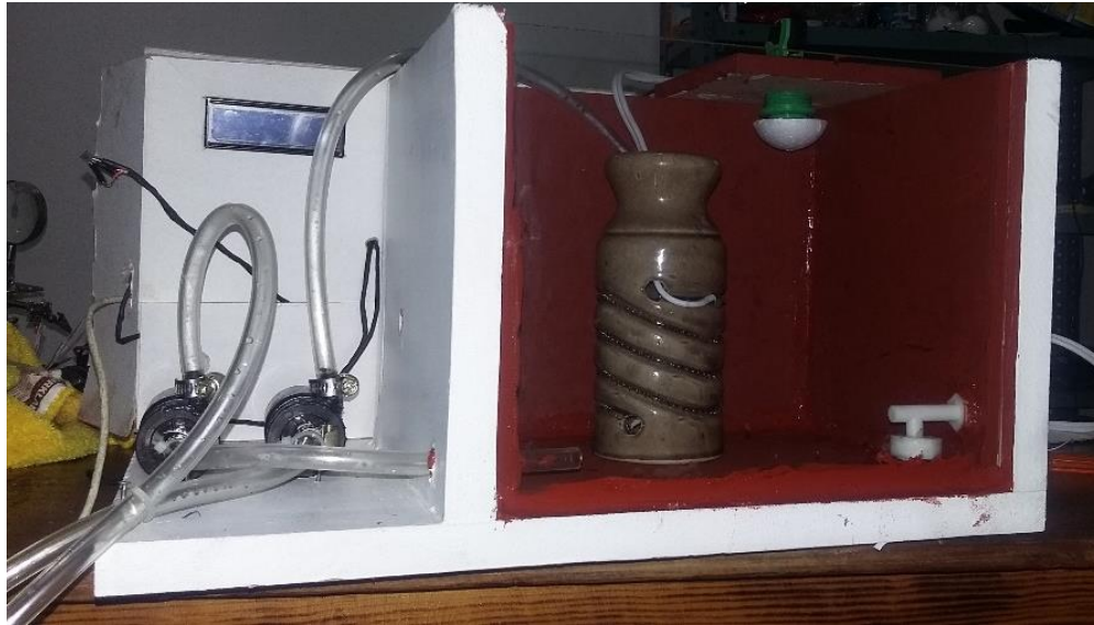
Figura 29. Sistema de control y tanque de almacenamiento. Elaborado por los estudiantes que integran el equipo 4
