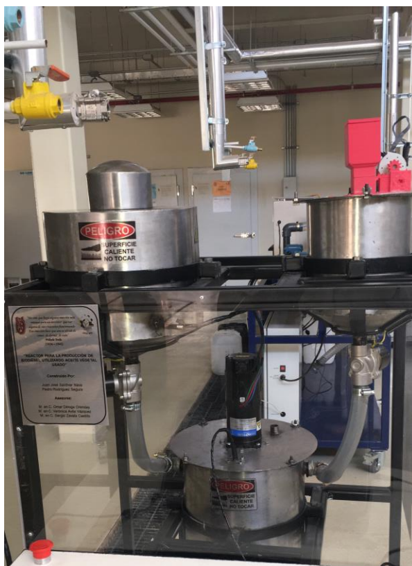
Figura 19. Prototipo utilizado para la producción de biodiésel. (Prototipo diseñado por: Juan José Saldivar y Pedro Rodríguez)
