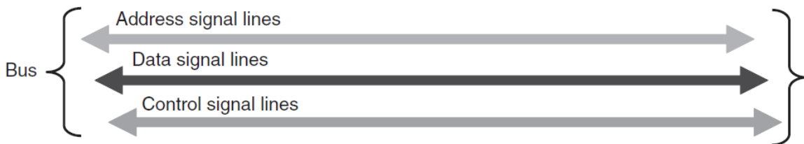
Figura 3. Tipos de señales dentro de un bus
