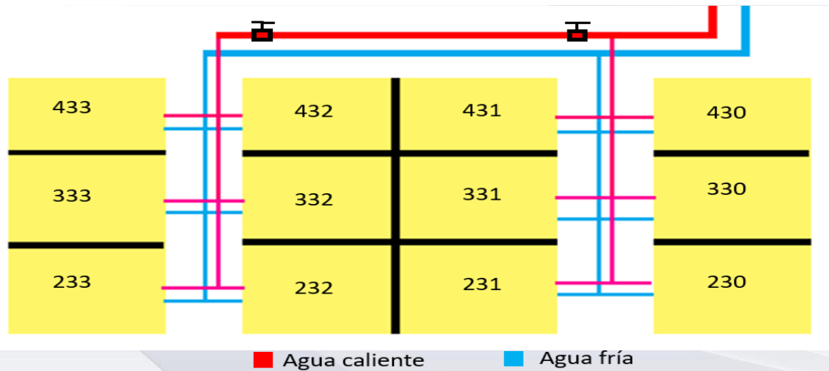
Imagen 4. Distribución de las líneas de agua hacia las habitaciones de cada edificio.
