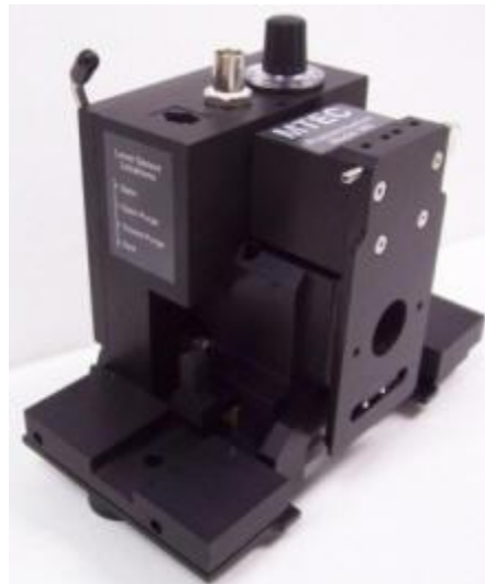
Figura 18. Celda Fotoacústica MTEC 300.
