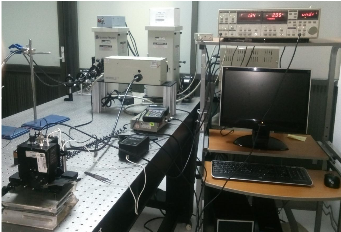
Figura 27. Sistema de Espectroscopia fotoacústica utilizado en el laboratorio.
