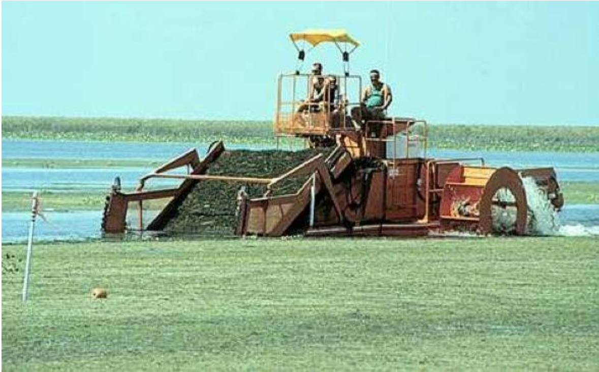
Figura 3. Método mecánico (dragas) para el control de lirio acuático. (Tomada del sitio de internet: http://www.hobbykwekers.nl )
