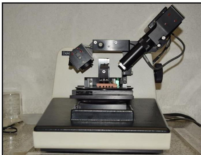
**Figura 13. Dektak<sup>3</sup> ST, Sistema de medición de perfil de superficie**
