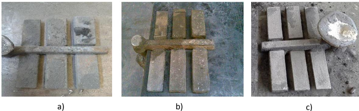
*Figura 19 Fundiciones de hierro dúctil fabricadas a) hierro dúctil s/a, b) hierro dúctil aleado con 0.1% V y c) hierro dúctil aleado con 0.4% V*
