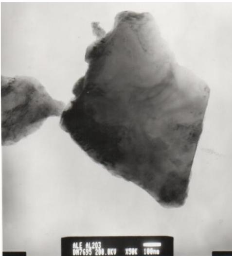
Figura 2.3 Imagen de una partícula de  $\text{Al}_2\text{O}_3$  obtenida en microscopía electrónica de transmisión.
