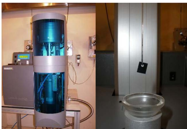
Figura 8. Termobalanza SETARAM Setsis Evolution y colocación de la muestra.
