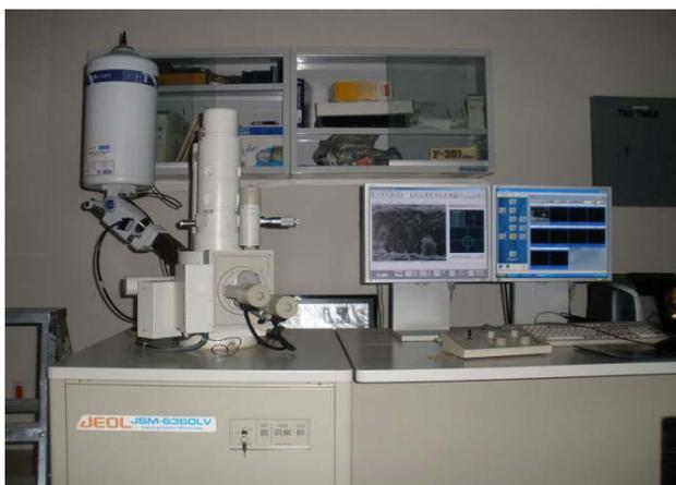
Figura 10. Microscopio Electrónico de Barrido
