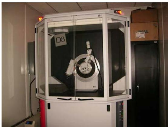
Figura 9. Difractómetro de Rayos X D8 FOCUS.
