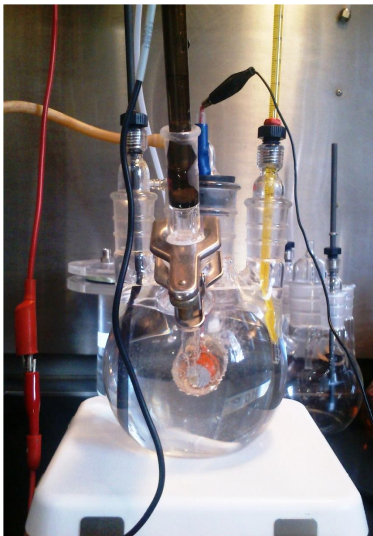
Figura 27. Celda de corrosión completamente acondicionada, y lista para la prueba electroquímica
