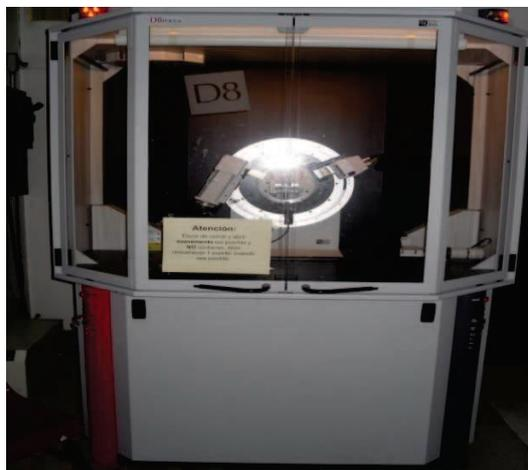
Figura 12 Difractometro de rayos X modelo Bruker D8 FOCUS.
