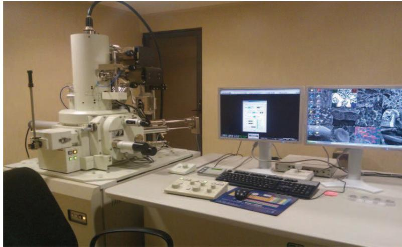
Figura 13 Microscopio Electrónico de Emisión de Campo JEOL MOD. JSM-6701-F
