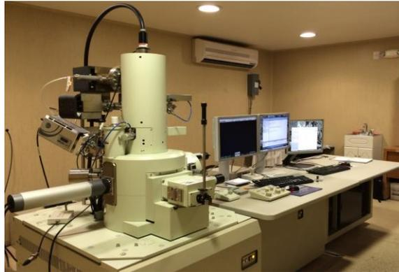
**Figura 13.** Microscopio electrónico de barrido de alta resolución marca JEOL modelo JSM-6701F.
