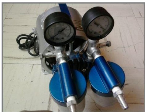
Figura III.15 Bomba de vacío empleada en la destilación.
