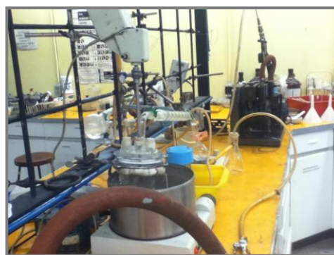
Figura III.16 Dispositivo montado para la extracción del solvente.
