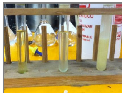
Figura III.34. Pruebas de solubilidad del producto B , se observa la prueba con tolueno, centro acetato de n-butilo y derecha 2-propanol
