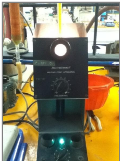
Figura III.29 Equipo Electrothermal para determinar el punto de fusión
