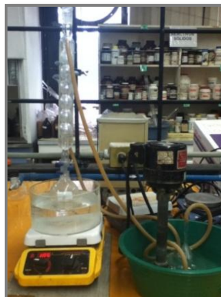
Figura III.45 Dispositivo montado para determinar el índice de hidroxilo
