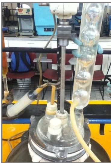
Figura III. 40 Dispositivo montado para determinar los parámetros cinéticos de la reacción.
