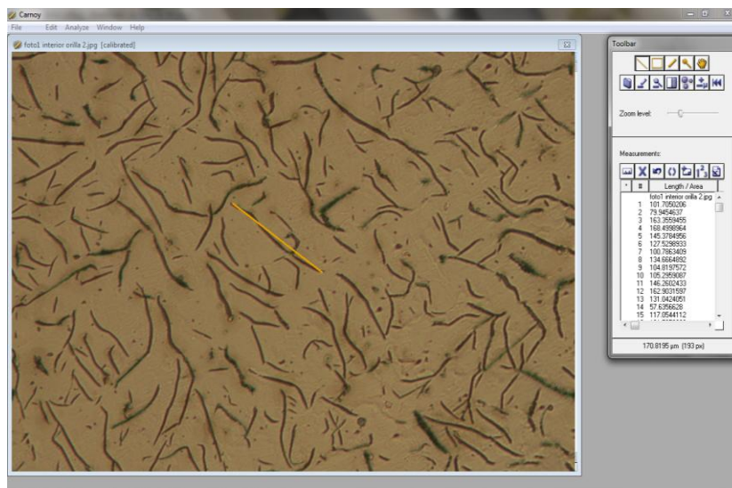
Figura 35. Programa carnoy utilizado para medir hojuelas de grafito.
