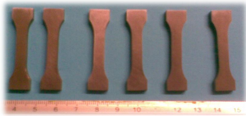
Figura 41. Probetas de tensión obtenidas de las pista de frenado del disco de freno.
