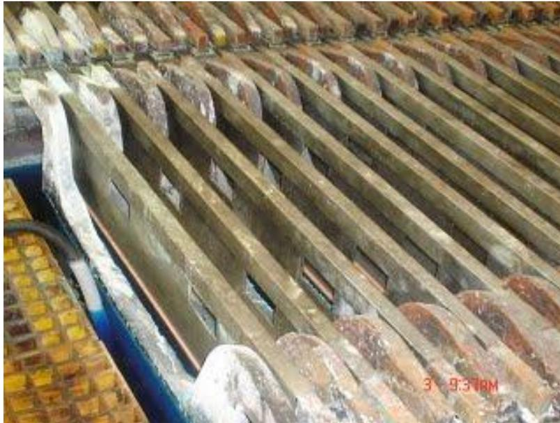
. Fig. IV Celdas de refinación de cobre.
