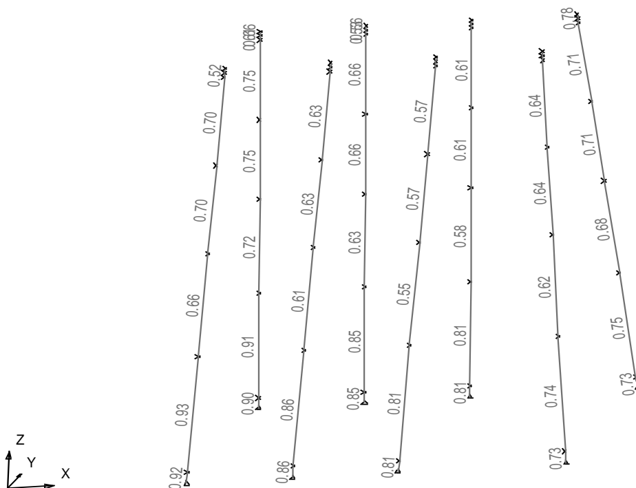
Fig. 4.5.1 Relaciones de esfuerzos máximos en pilotes.
