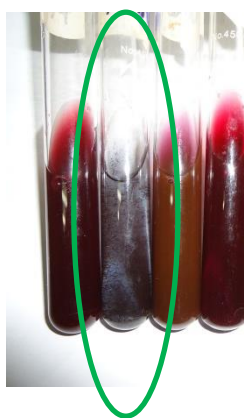
Figura 27.- AuNPs sintetizadas del extracto de noni. A simple vista se observan las partículas de gran tamaño y la sedimentación.
