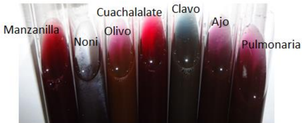
Figura 25.- Nanopartículas de oro sintetizadas a mayor concentración.
