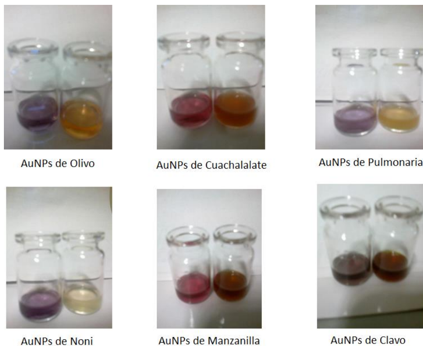
Figura 18.- Nanopartículas de oro Sintetizadas. A la izquierda se encuentra la solución de nanopartículas sintetizadas y a la derecha el extracto.
