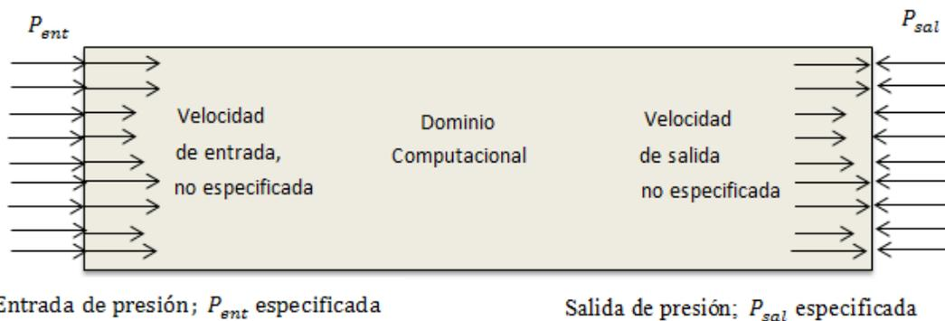
Fig. 3.4 En una entrada o salida de presión se especifica la presión sobre la cara pero no puede especificarse la velocidad a través de la cara. Cuando la solución DFC converge la velocidad se ajusta a sí misma de tal manera que se cumplan las condiciones de frontera de presión prescritas [18].
