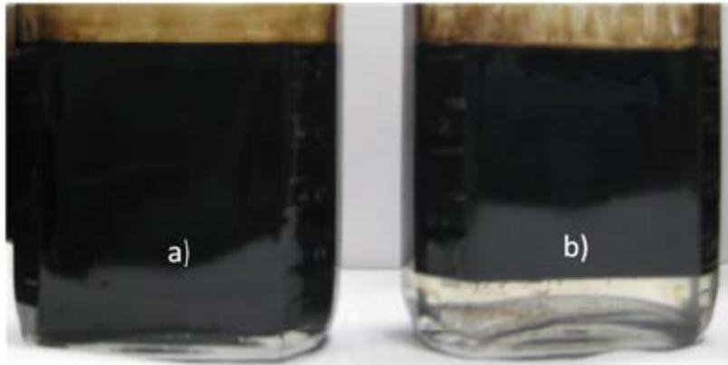
**Figura 28:** Ejemplo de los comportamientos obtenidos en las pruebas de botella. a) “Mordedura” de la emulsión. b) Separación franca de agua limpia.
