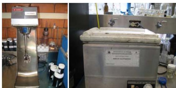
**Figura 19:** Fotografía de los diferentes equipos utilizados en el trabajo experimental. Izquierda, Mixer y derecha, Baño de Calentamiento, material utilizado en las pruebas de botella.
