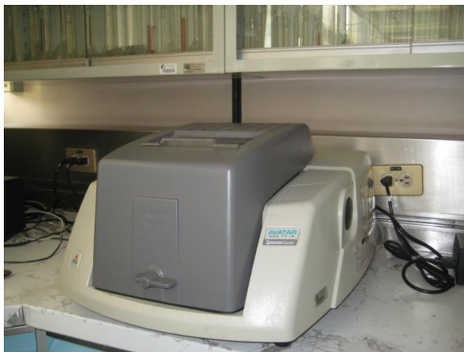
**Figura 23:** Equipo de FTIR utilizado en la Elucidación Estructural de las muestras analizadas del I.M.P., obteniéndose los diferentes espectros de IR.
