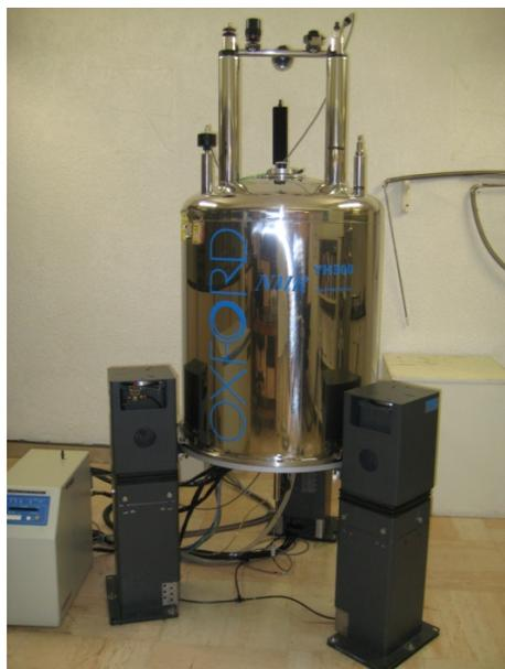
**Figura 24:** Equipo de RMN del Laboratorio de Resonancia Magnética del I.M.P. Este equipo puede realizar los espectros de Hidrógeno, según las condiciones experimentales y modo de ejecución.
