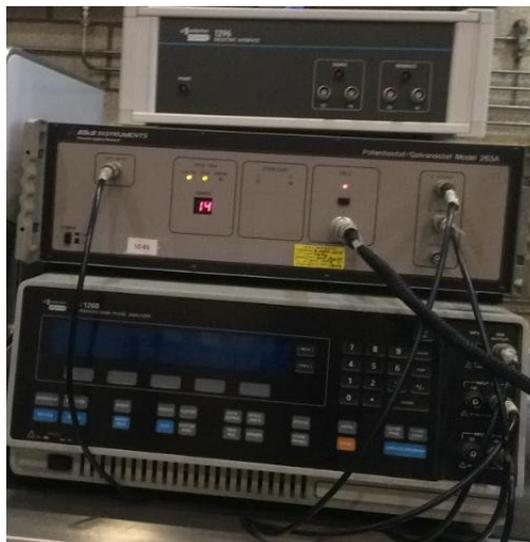
*Figura 7.* Potenciostato- Galvanostato para mediciones electroquímicas.
