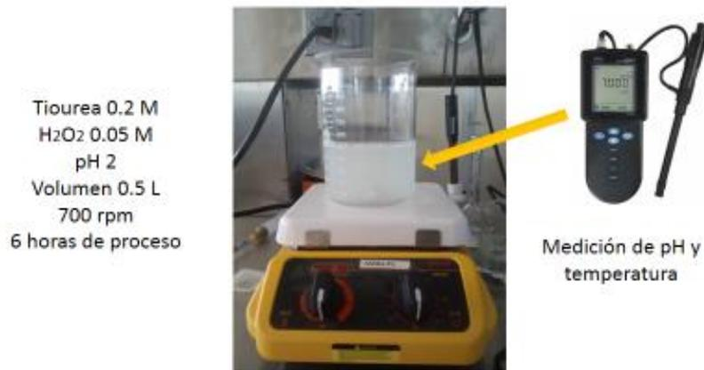
**Figura 3.-** Esquema experimental de la lixiviación para la extracción de plata.
