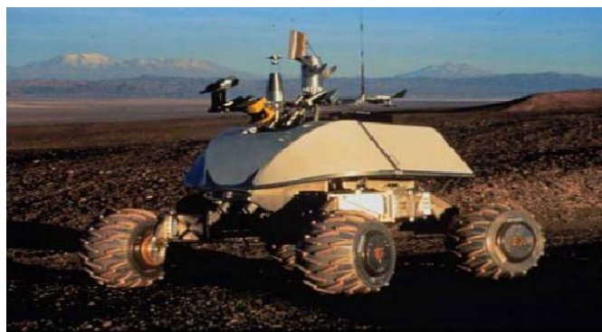
Figura 1.6. Sistema con dirección articulada
