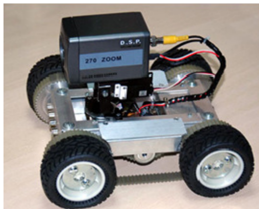
Figura 1.8.i-Bot (Robot limpia tubería)
