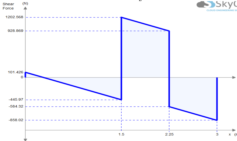
Figura 3.95. Diagrama de Fuerza cortante en la viga soporte. Modelo propio.
