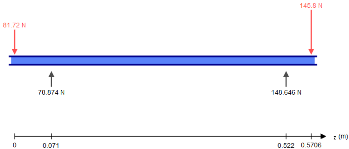
Figura 3.22. Diagrama de Cuerpo libre del plano ZX del eje con reacciones. Fuente propia.
