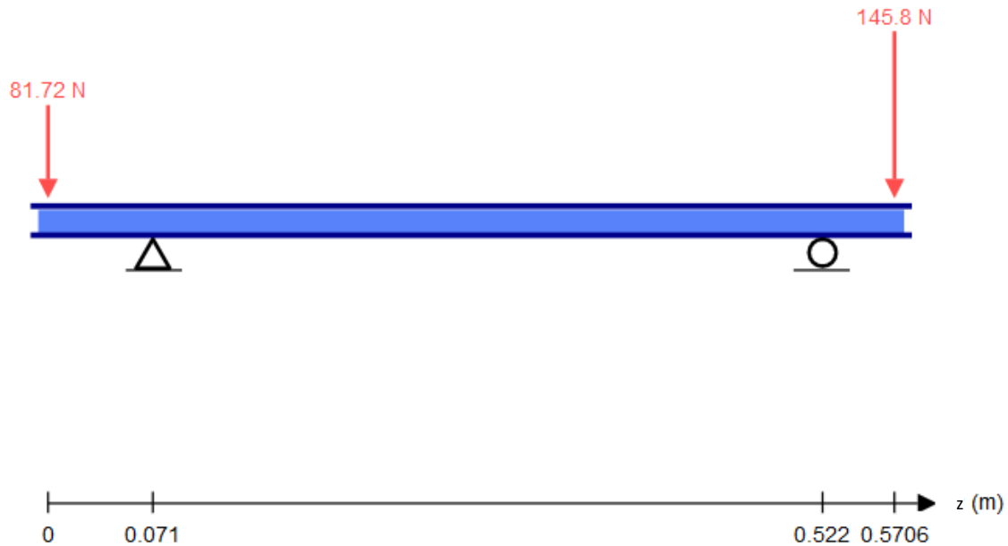
Figura 3.21. Diagrama de Cuerpo libre del plano ZX del eje. Fuente propia.
