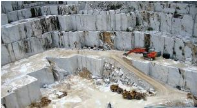
Figura 2.2. Extracción mediante el corte de Hilo adiamantado. Perfil de Mercado del Mármol, por Coordinación General de Minería, 2014, ciudad de México: Secretaría de Economía.
