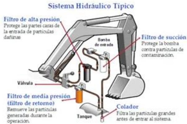
Figura 13 Componentes de un Sistema Hidráulico
