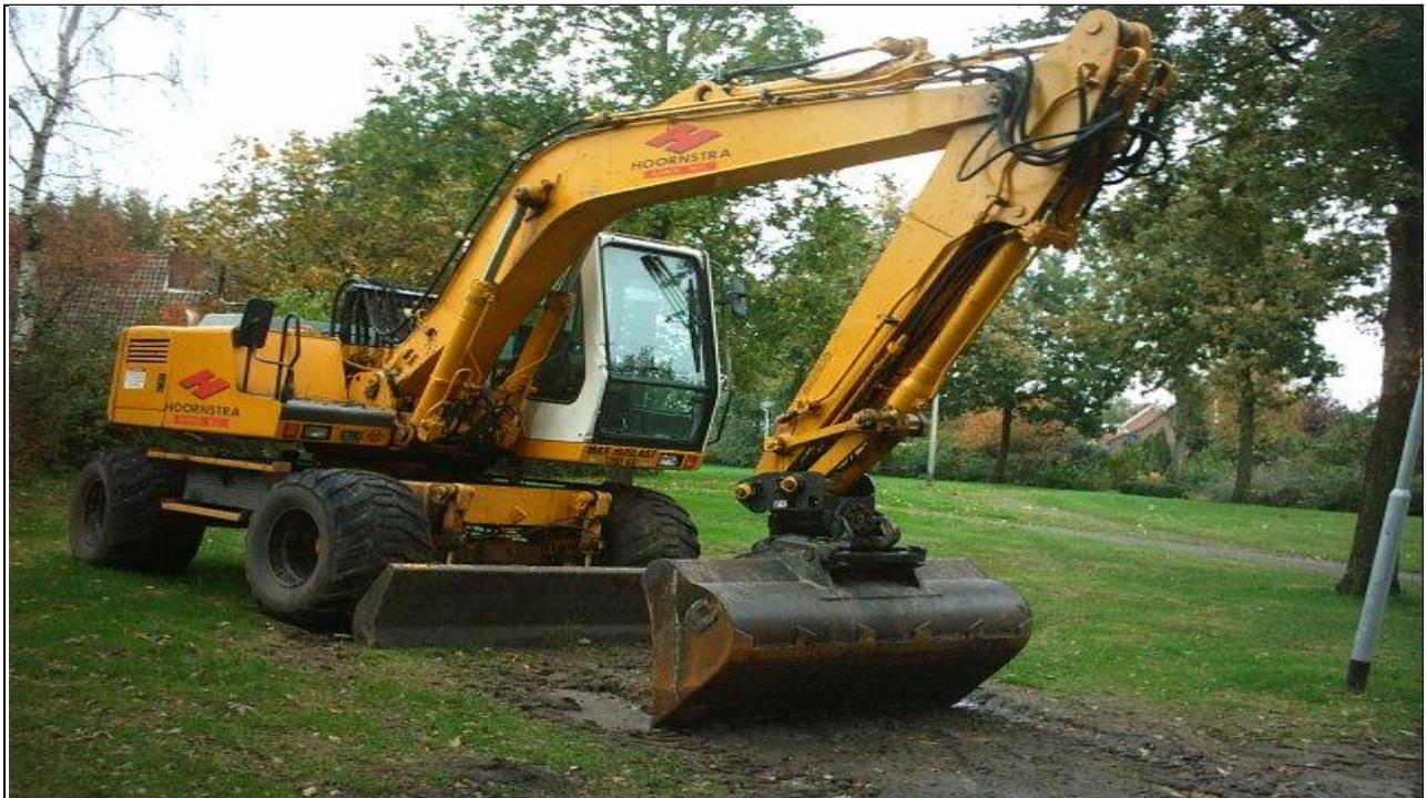
Figura 15 Cilindros Hidráulicos usados en Maquinaria de la Construcción
