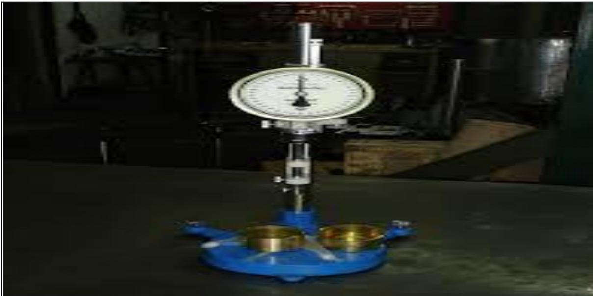
Fig 25 Equipo para medir el grado de penetración según la ASTM
