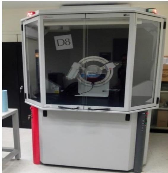
*Figura 24 Difractometro D8 Focus Bruker.*
