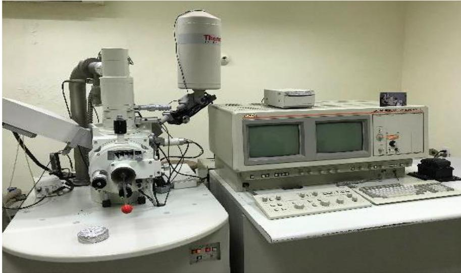
*Figura 23 Microscopio Electrónico de Barrido marca JEOL JSM-6300.*
