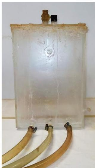
**Figura 19 Geometría de la celda de impacto.**
