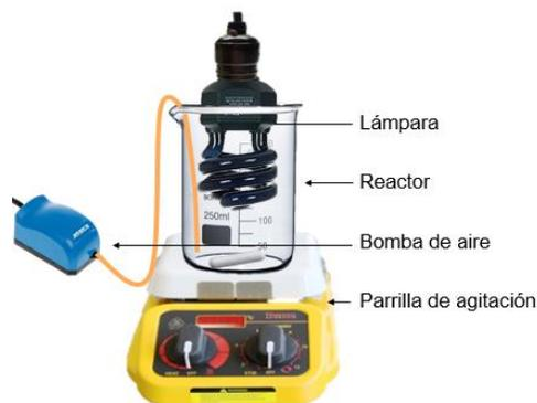
Figura 21. Montaje experimental del sistema fotocatalítico.
