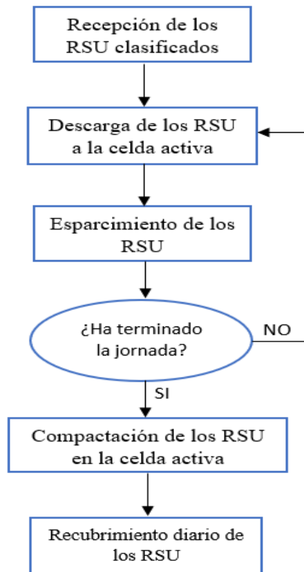
Figura 3.11 Diagrama de Bloques de la operación del relleno sanitario. Fuente: Elaboración propia
