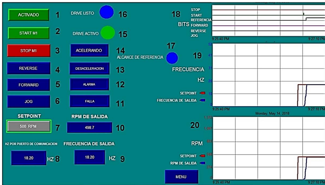
Figura 3-61. Pantalla de control manual de motor
