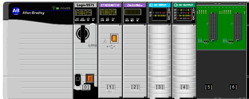
Figura 2-14. ControlLogix 1756-L62 instalado en chasis.
