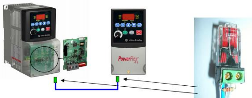
Figura 2-41. Terminales del bus RS485
