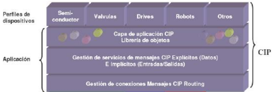
Figura 1-10. Capas de aplicación del CIP
