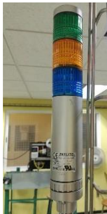
Figura 2-11. Torre de señales de 3 niveles
