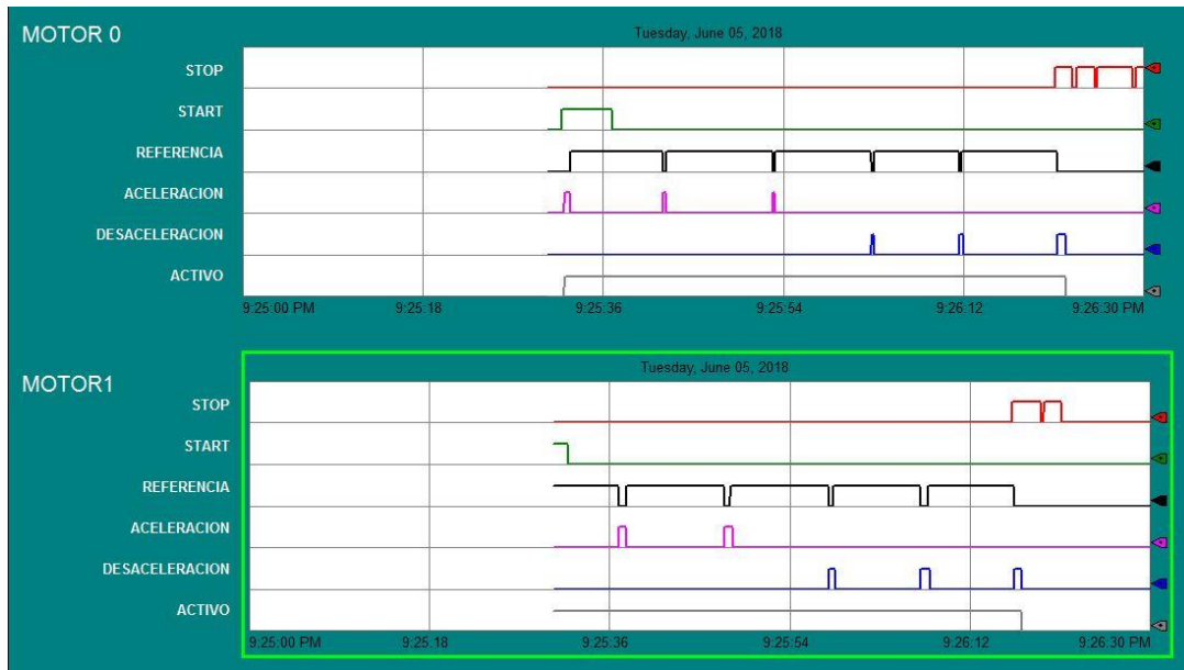
Figura 4-10. Comportamiento de bits de secuencia automática 2
