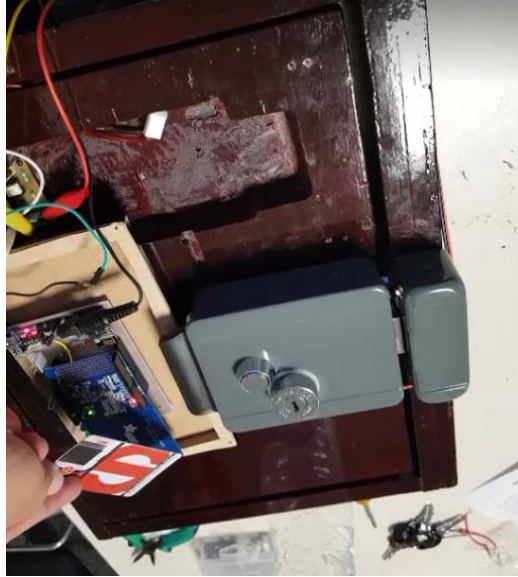
Figura 4.27. Prototipo con nueva cerradura eléctrica
