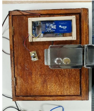
Figura 3.13. Circuito implementado en la puerta
