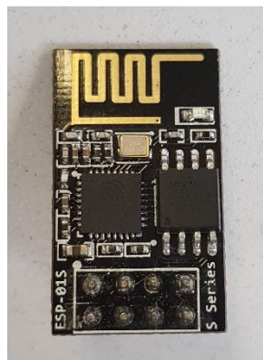
Figura 3.4. Módulo Wi-Fi ESP8266.
