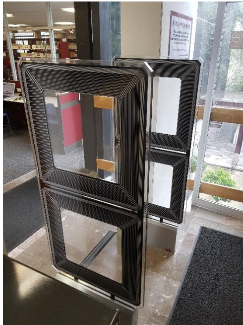
Fig. 2.2 Sistema de Radio Frecuencia implementado en la BNCT del IPN
